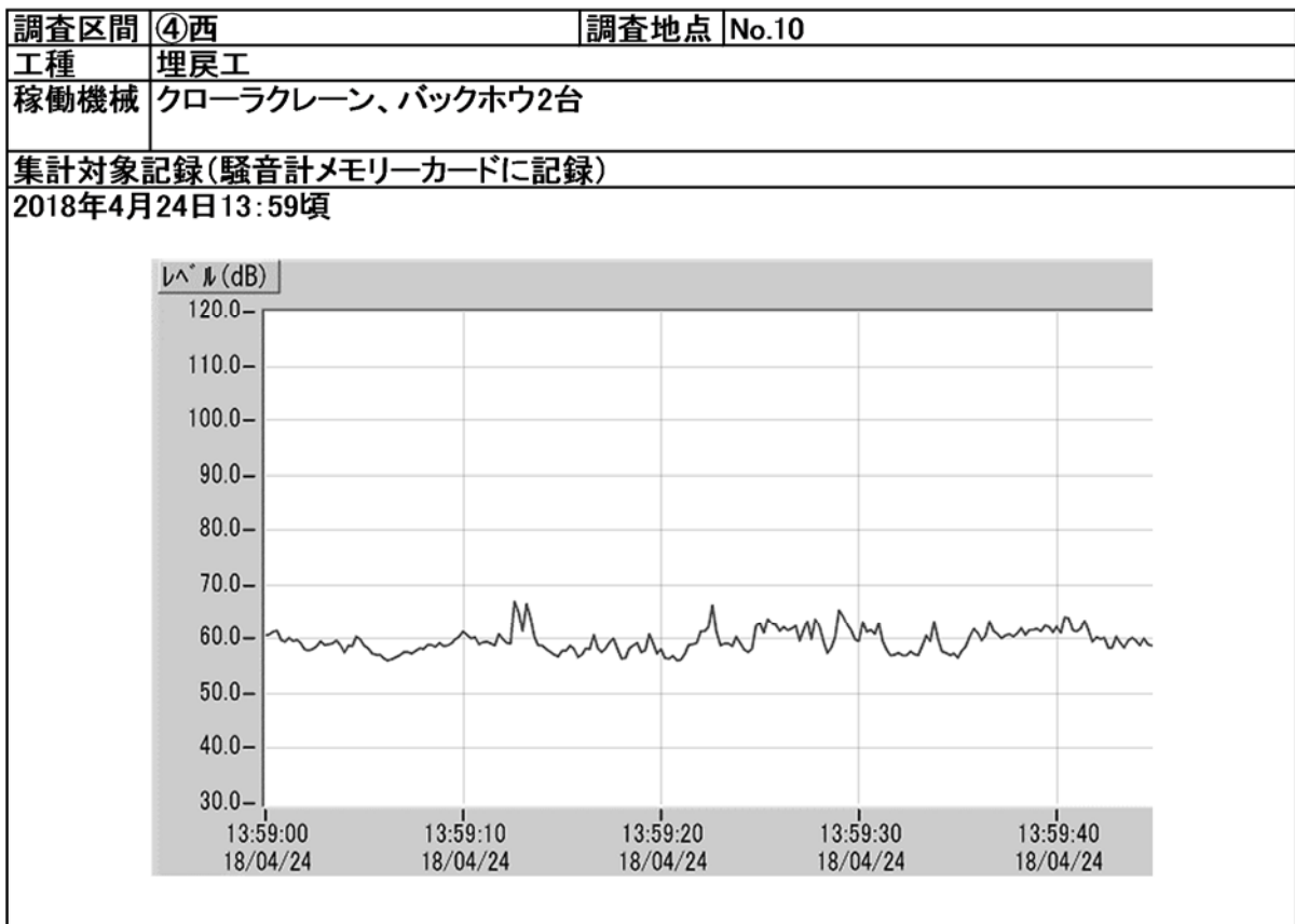
図-1(20) 建設作業騒音の測定記録 (④西 No.10 (埋戻工))
