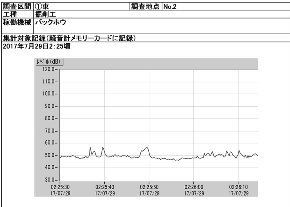
図-1(2) 建設作業騒音の測定記録 (①東 No.2 (掘削工))
