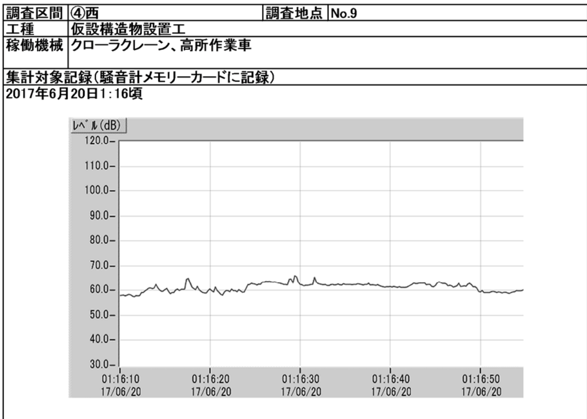
図-1(14) 建設作業騒音の測定記録 (④西 No. 9 (仮設構造物設置工))
