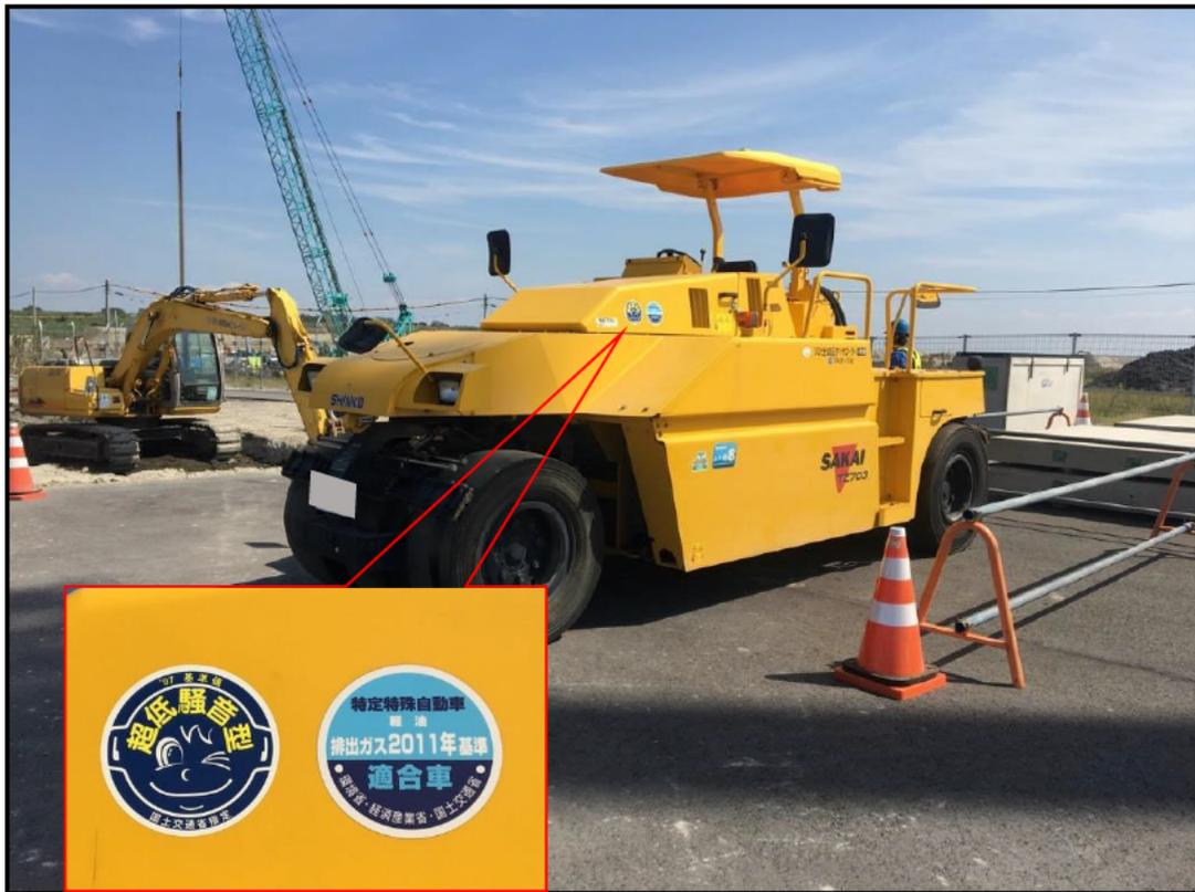
写真2-2 排出ガス対策型・超低騒音型建設機械の使用状況
