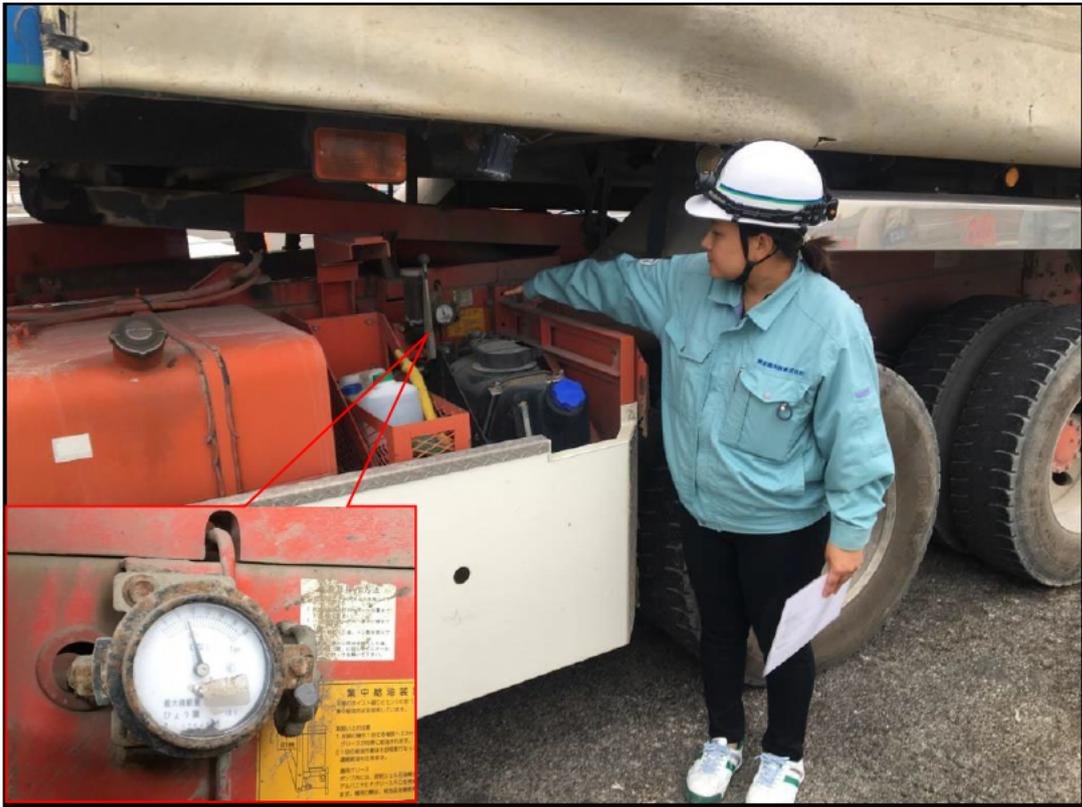
写真2-4 計量装置による過積載の確認状況
