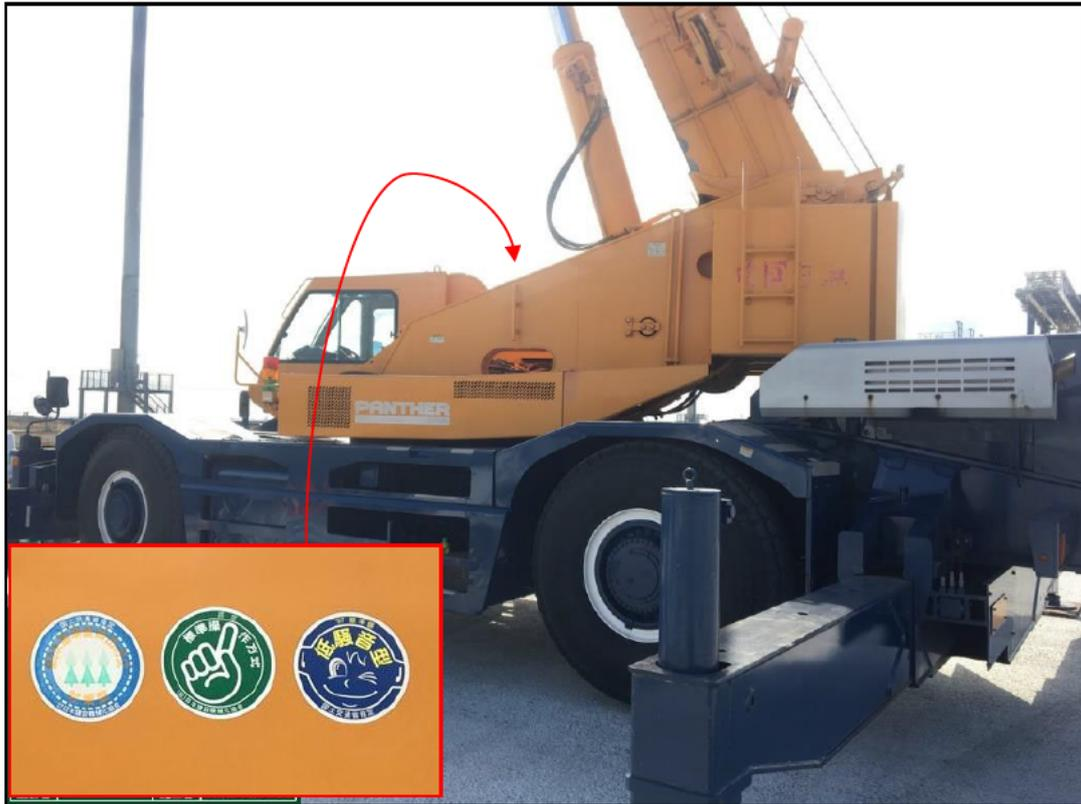
写真2-1(1) 排出ガス対策型・低騒音型建設機械の使用状況
