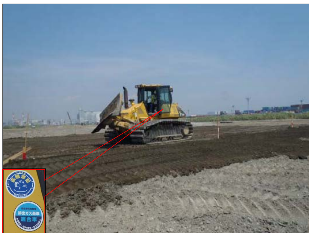
写真3-4(2) 排出ガス対策型・低騒音型建設機械の使用状況（ブルドーザ）
