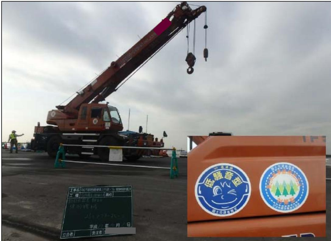
写真1-3(1) 排出ガス対策型・低騒音型建設機械の使用状況
