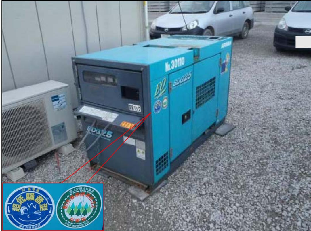
写真1-3(3) 排出ガス対策型・超低騒音型建設機械の使用状況
