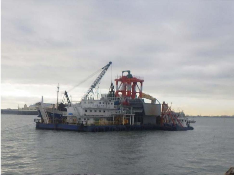
写真5-4 トレミー台船の使用状況
