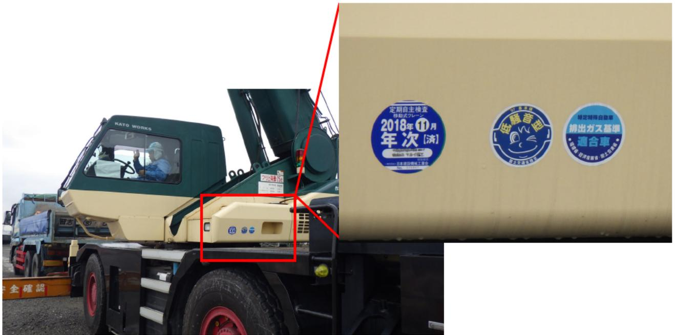
写真6-1 排出ガス対策型建設機械の使用状況
