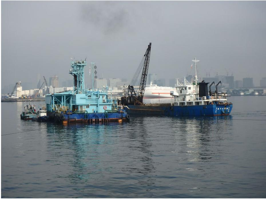
写真6-5 トレミー台船の使用状況
