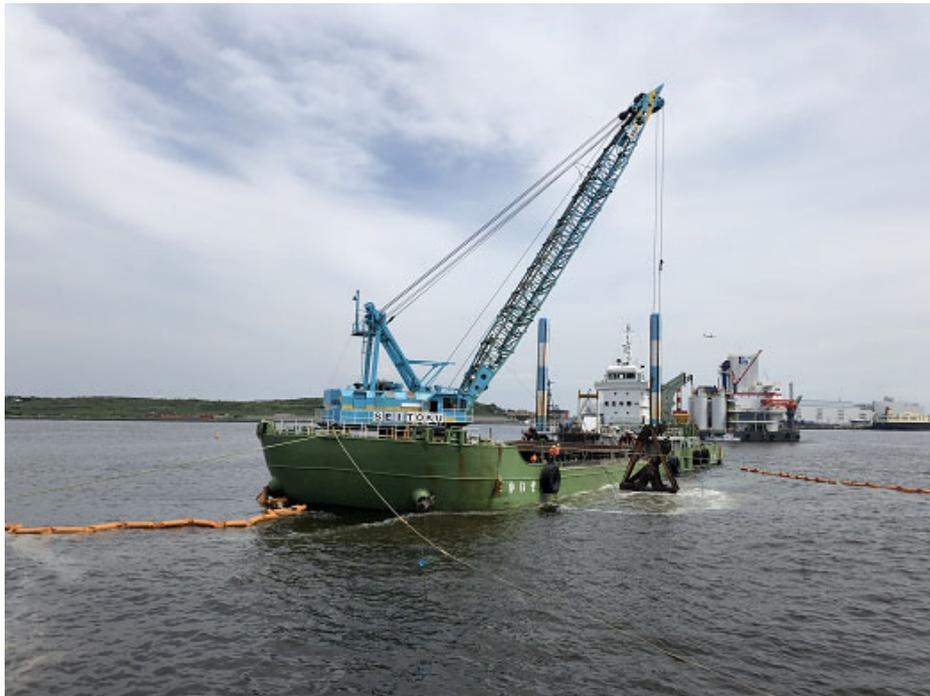
写真6-4 汚濁防止膜の使用状況
