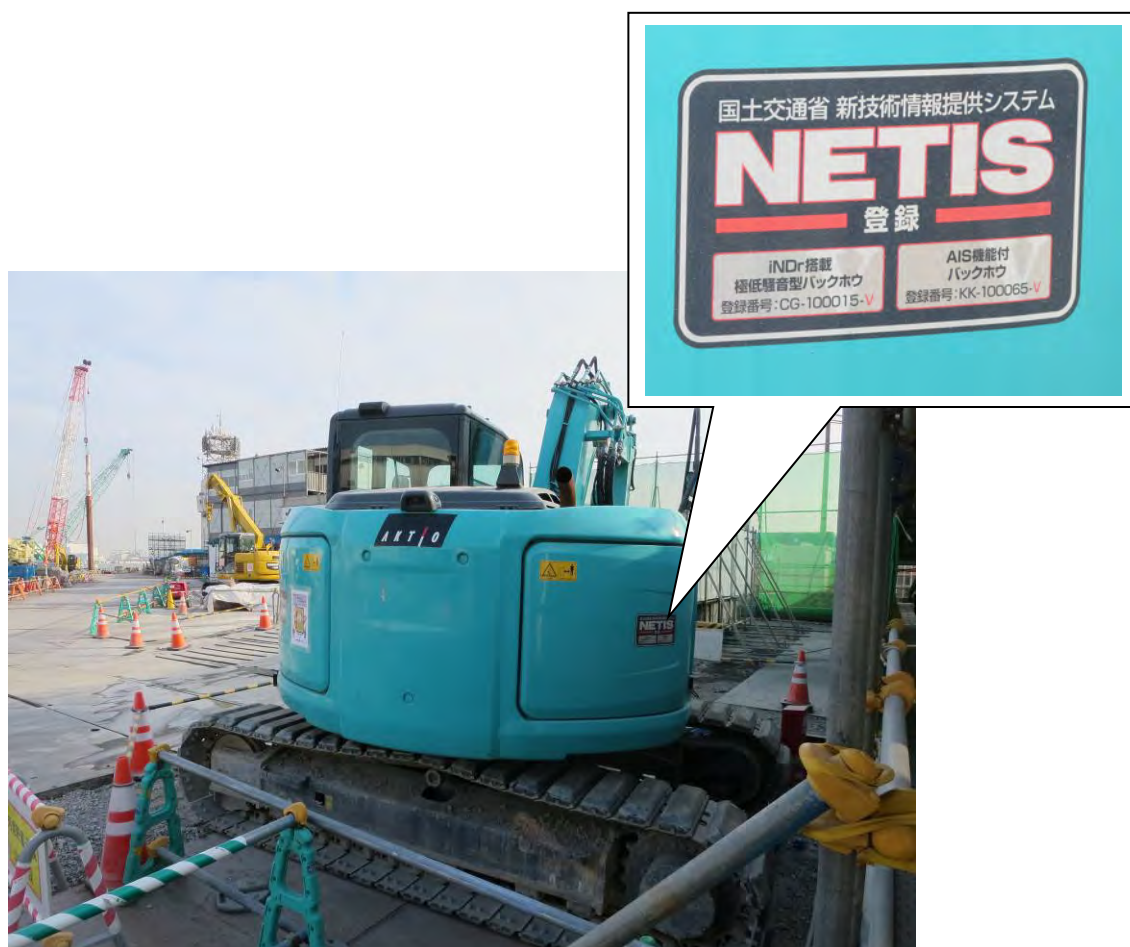
写真2-4 NETIS登録極低騒音型バックホウの使用状況
