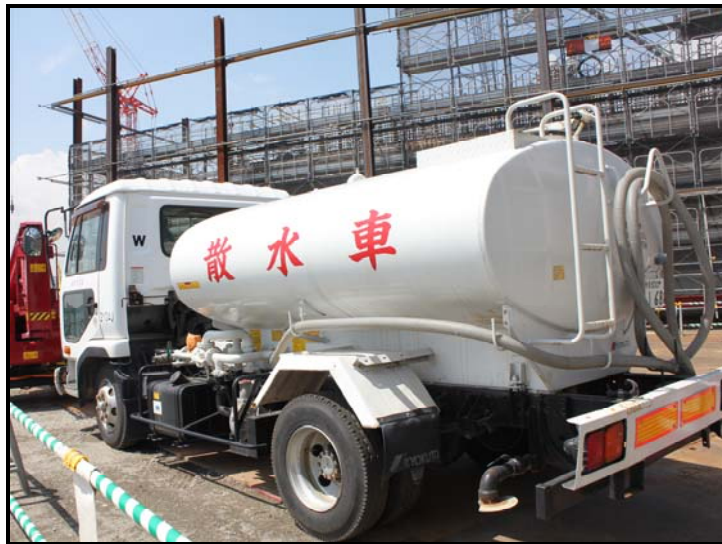
写真7-7 散水車の使用状況
