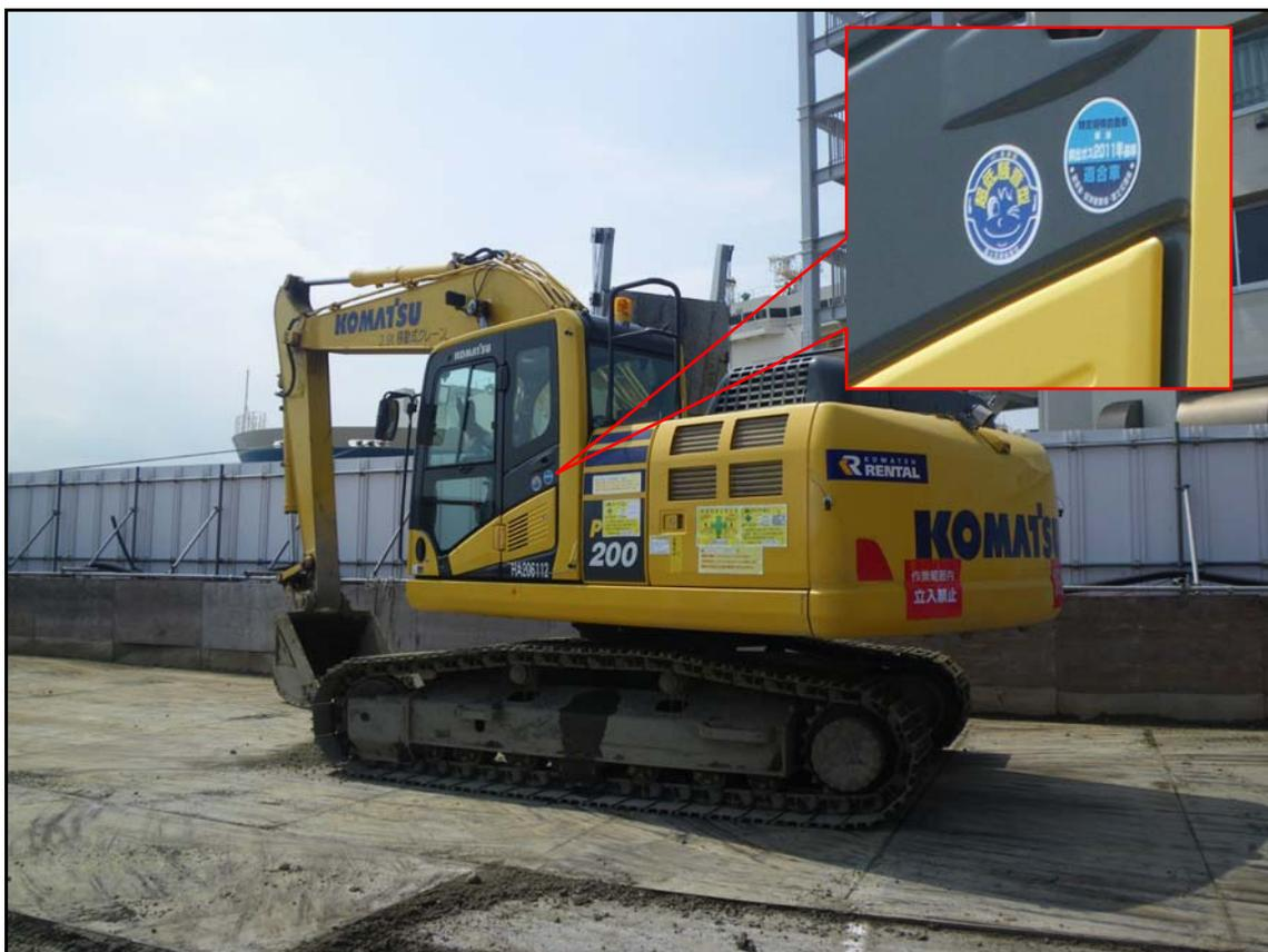
写真1-1 排出ガス対策型・超低騒音型建設機械の使用状況
