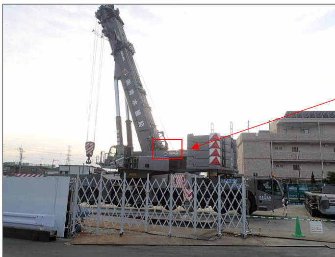
写真 1-1 オールテレーンクレーン (650 t 吊) DEMAG AC700
