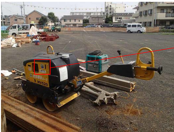
写真 1-2 (2) 超低騒音型建設機械の使用状況（ハンドガイドローラ）（平面部）
