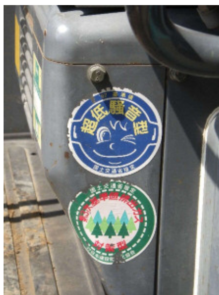
写真 2-2(2) 掘削工における環境保全措置の実施状況 (超低騒音型建設機械の導入)
