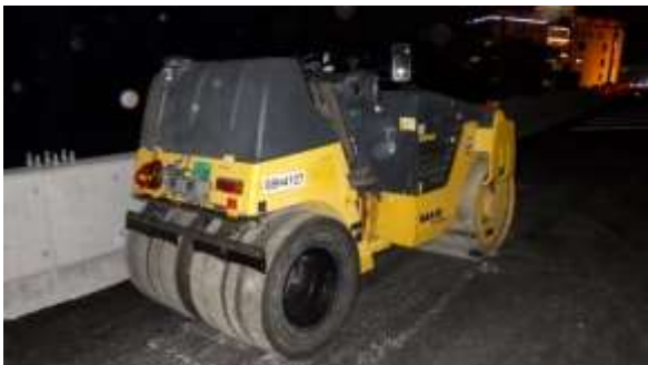
2.5t コンバインドローラ (振動ローラ) 酒井重工業 TW502-1(低騒音型)
