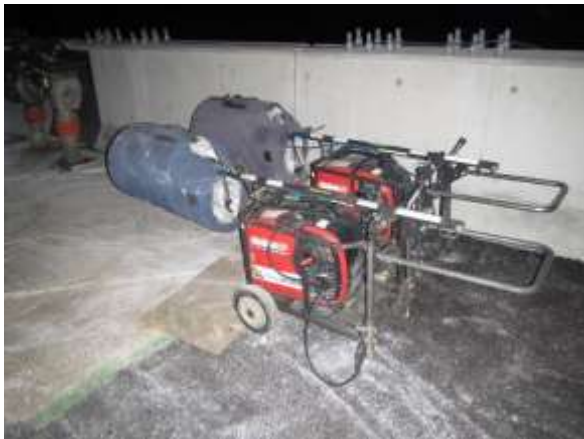
発電機 新ダイワ IEG1600M(超低騒音型)
