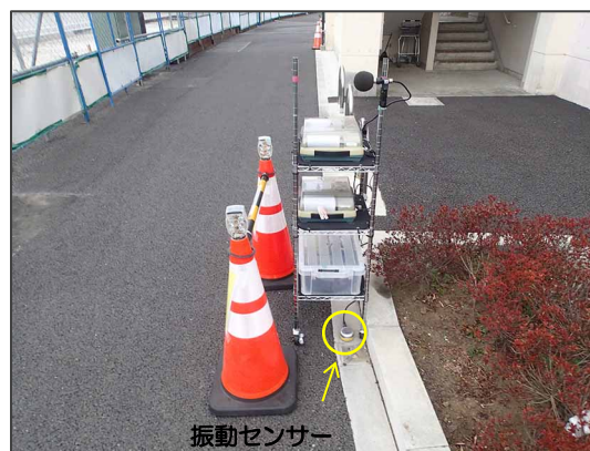
写真 2-1 (2) 振動測定状況 (No. 2 地点)
