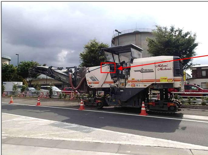
写真 3-5 路面切削機 (470kW) Wirtgen W210
