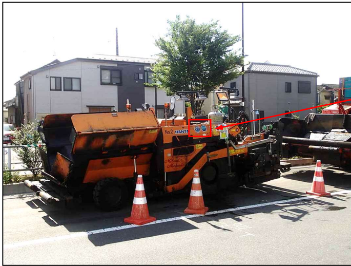
写真 1-1(2) アスファルトフィニッシャ(最大舗装幅 4.5m) 範多機械(株) F45W3
