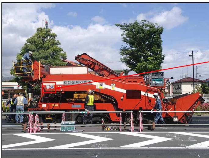
写真 1-1(3) 二層式アスファルトフィニッシャ(最大舗装幅 4.5m) (株)新潟鉄工所 NMAP60TVTM 3
