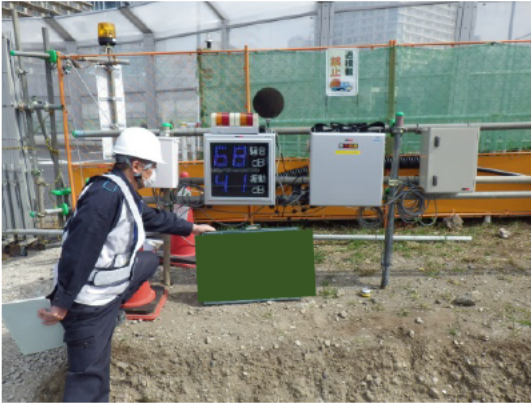
写真 3-25 環境保全のための措置の実施状況 (騒音計・振動計の設置)
