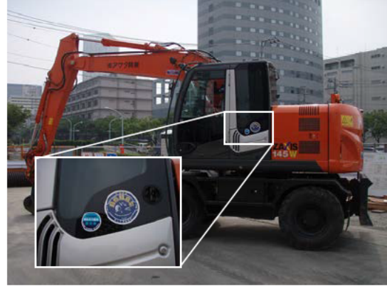
写真 3-14 環境保全のための措置の実施状況 (超低騒音型建設機械)
