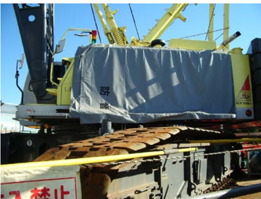
写真 3-23 環境保全のための措置の実施状況 (クローラークレーンのエンジン部への防音シートの設置)
