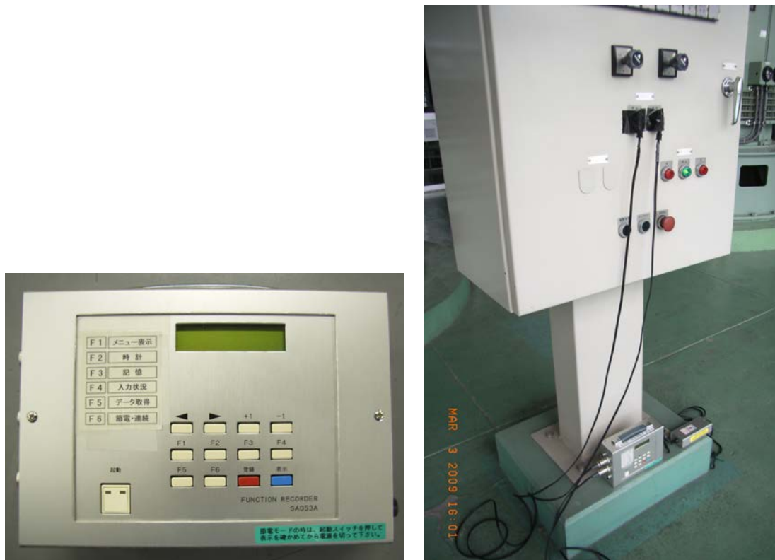
写真 7 稼働記録計の例（左図：本体 右図：使用状況）
