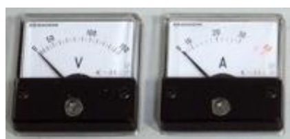
写真 3.9 操作盤の電圧・電流計
