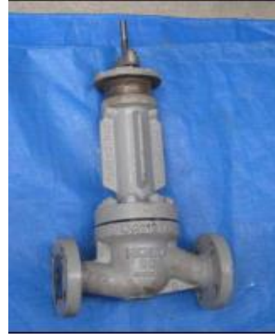
写真 8.6 電子式膨張弁の外観 (20A フランジ面間 194mm)
