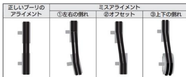
図 3.2 Vベルト摩耗の原因(芯ずれ)
