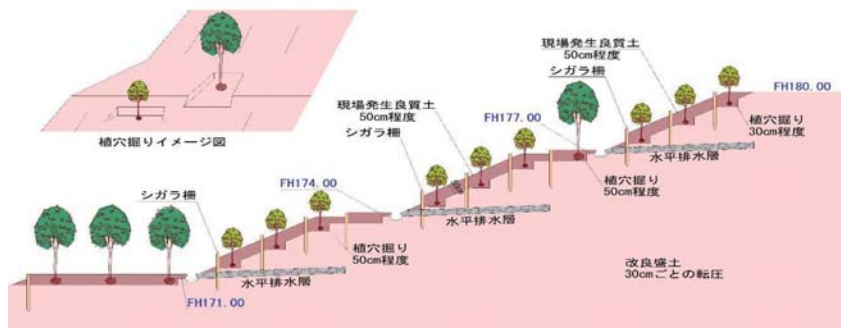
図 4-1-5-2 造成法面の緑化
