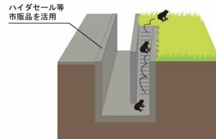
図 3-5-2-14 小動物に配慮した側溝イメージ図
