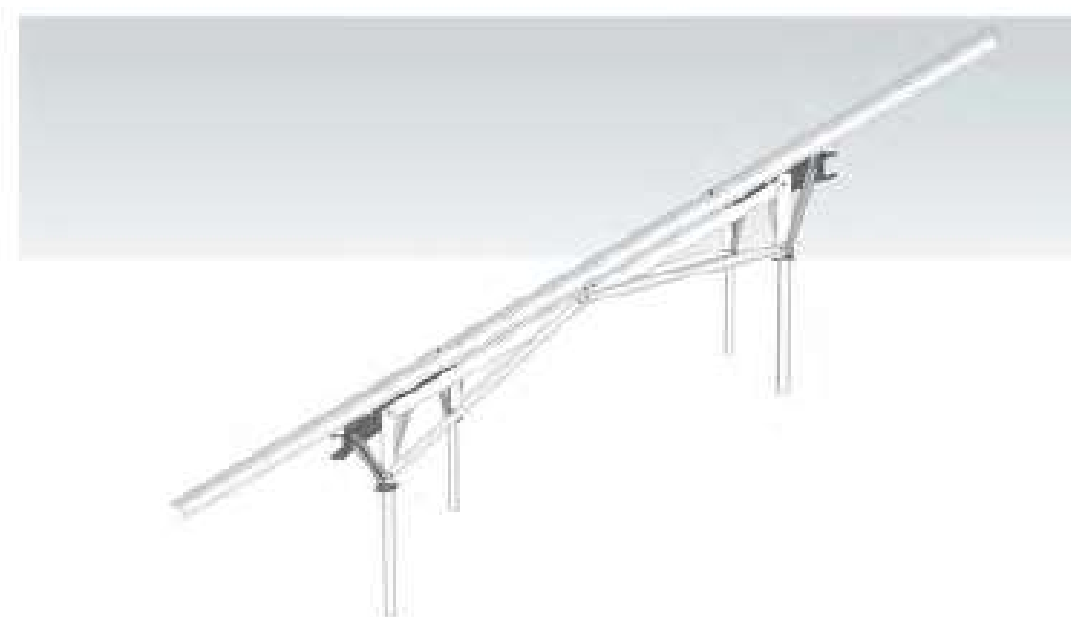
図 1.8-4 太陽光パネル (1 アレイ=6×3 モジュール) の立面イメージ図
