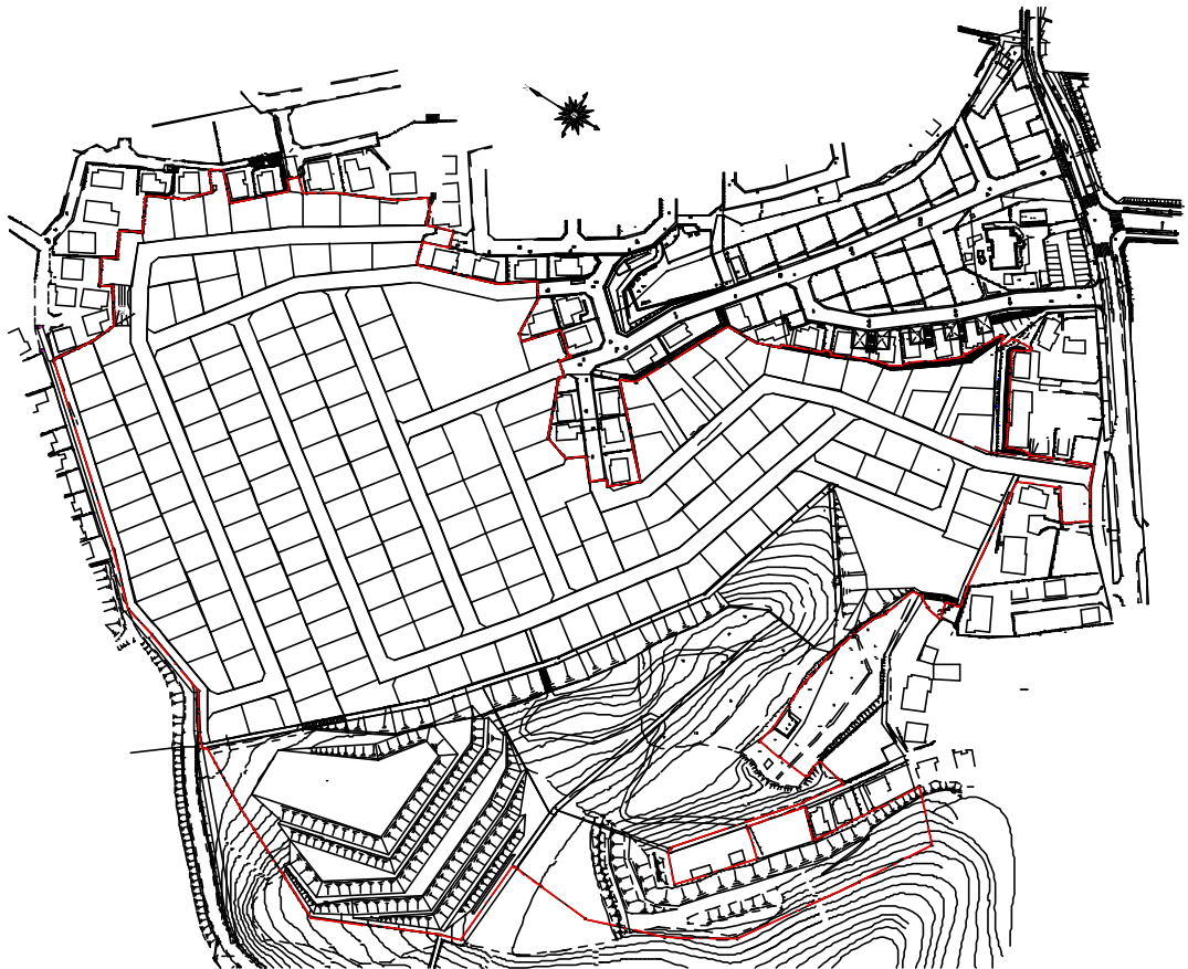
ステップ3 11か月から20か月まで 事業区域内宅地造成工事 切盛土工事（仕上りの高さまで）
