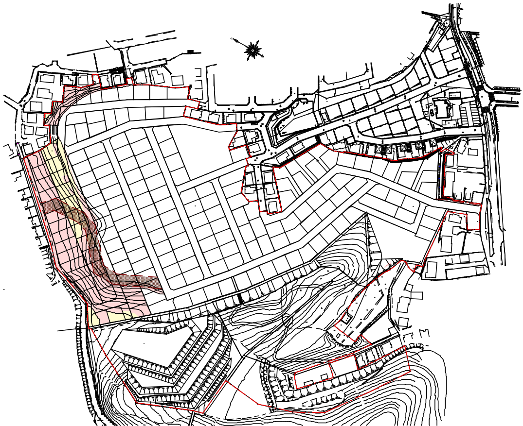
ステップ3 11か月から20か月まで 事業区域内宅地造成工事 切盛土工事（仕上りの高さまで）
