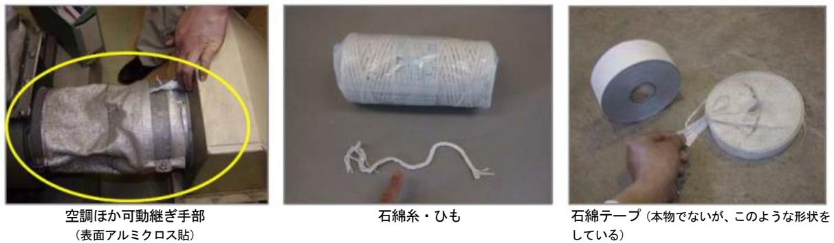
図45 石綿含有シール材の例 38)
