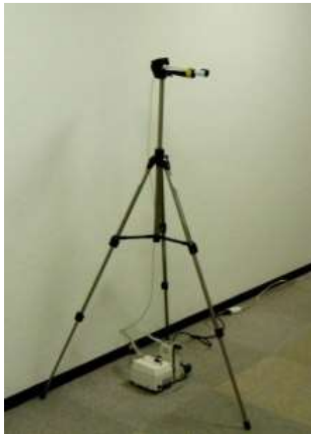
写真 20 空気中の石綿濃度測定
