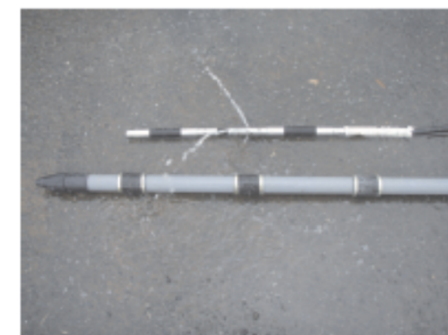
注入外管・内管からの送水状況
