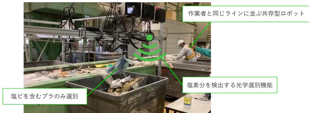
図 1-7 ヒト共存型選別ロボットのイメージ
