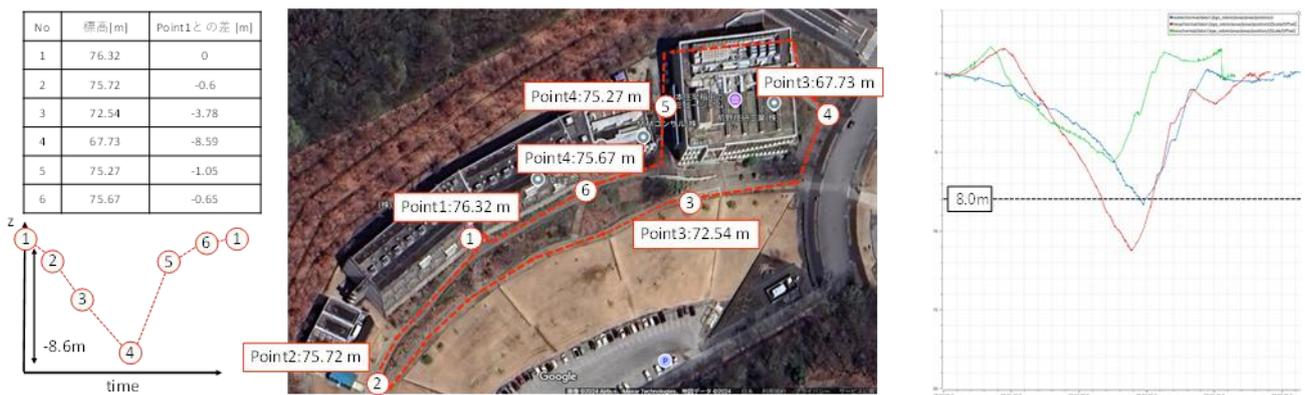
図 3-27 各 LiDAR の Z 位置の真値と測定結果 (青 : Ouster ・ 赤 : Hesai ・ 緑 : Livox)
