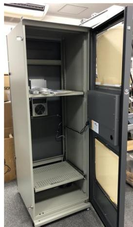
図 4-60 制御盤の格納容器 (写真)
