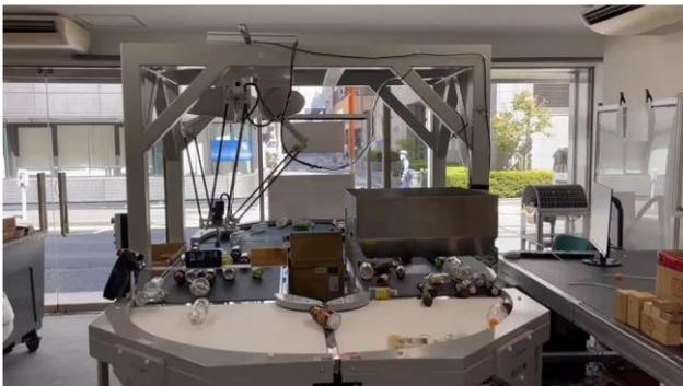
図 3-59 飲料容器のロボット選別(写真)
