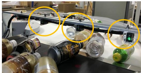
図 3-53 停止センサー(写真)
