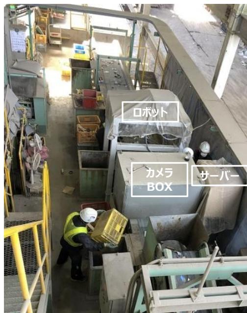
図 4-87 ロボット設置状況 (二次選別ライン)
