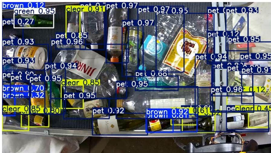
図 3-85 AI 画像認識結果 (Yolo8x) ※2024年10月1日時点
