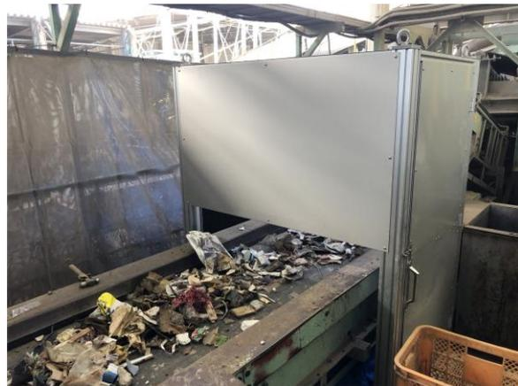
図 4-40 カメラ BOX の設置 (写真)
