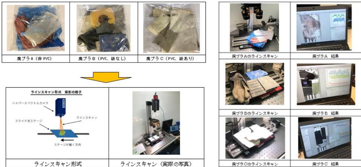
図 4-15 ハイパースペクトルカメラによる廃プラ判別システム
