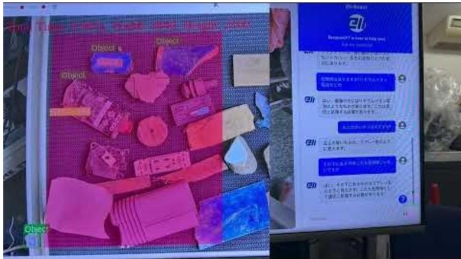
図 5-6 建設混合廃棄物処理施設のコンベヤ上で採取した試料の判別
