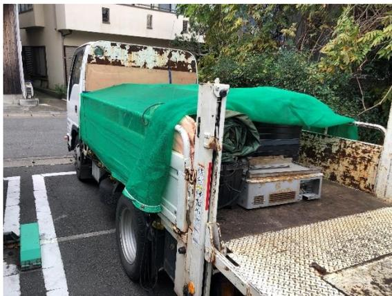
図 5.45. 飛散防止措置
