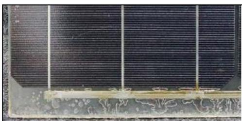
図 5.83. W1 の気泡発生状況（3000h 後）
