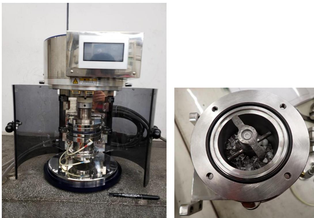
図 5.122. アトライタ (PWB-0007) 外観と容器内部
