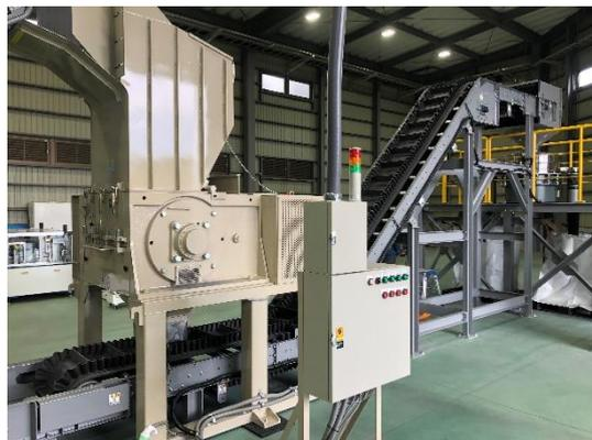
図 5.141. 実プロセスでの使用機器：破碎機
