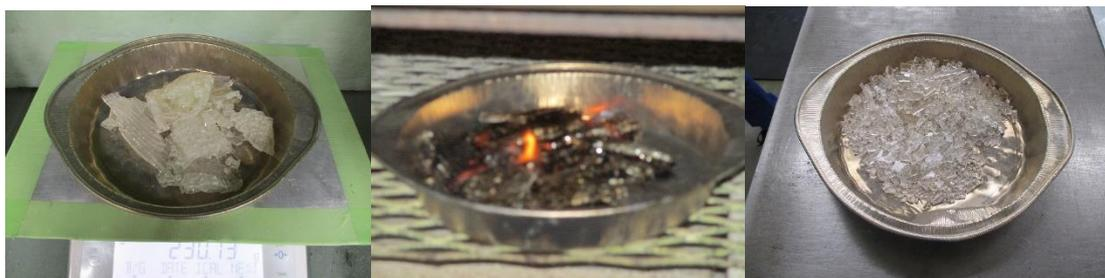
図 5.239.アルミパンに（左）20 kg カレット、（中）400℃で加熱処理、（右）処理後の試料外観
