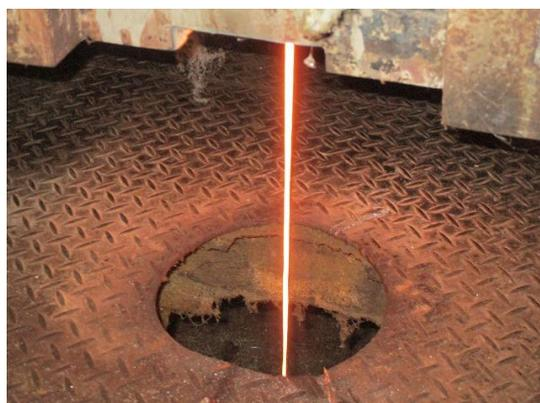
図 5.236. カバーガラス 50%-板ガラス 50%試料の試験のスピナー出口の安定しない繊維
