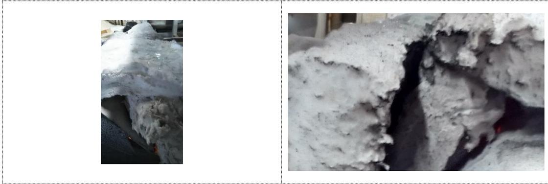
図 5.225. 煤が付着する前の熔解試験炉（左）、熔解試験炉内の煤（右）
