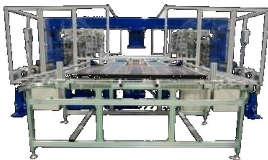
図 5.59. フレーム分離装置外観
