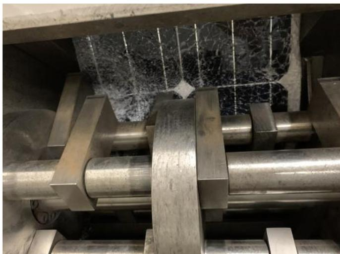
図 5.96. ハンマーミル回転部に絡んだ太陽光パネルサンプルの様子
