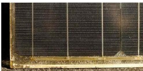
図 5.85. W2 の気泡発生状況（2000h 後）
