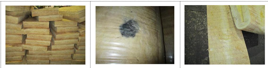
図 5.228. 不良品（密度不足）（左）、不良品（焼け焦げ）（中央）、良品（製品）（右）
