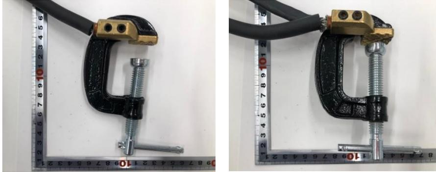
図 5.133. クランプ式電極
