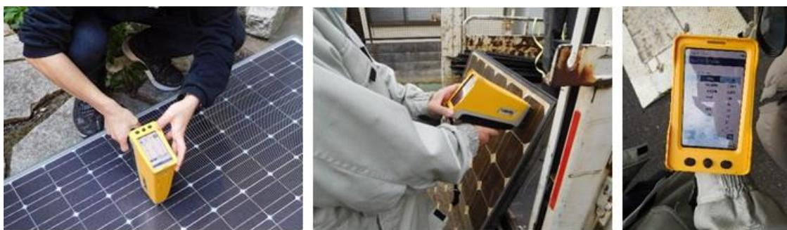
図 5.11. ハンディ XRF によるオンサイト分析の様子
