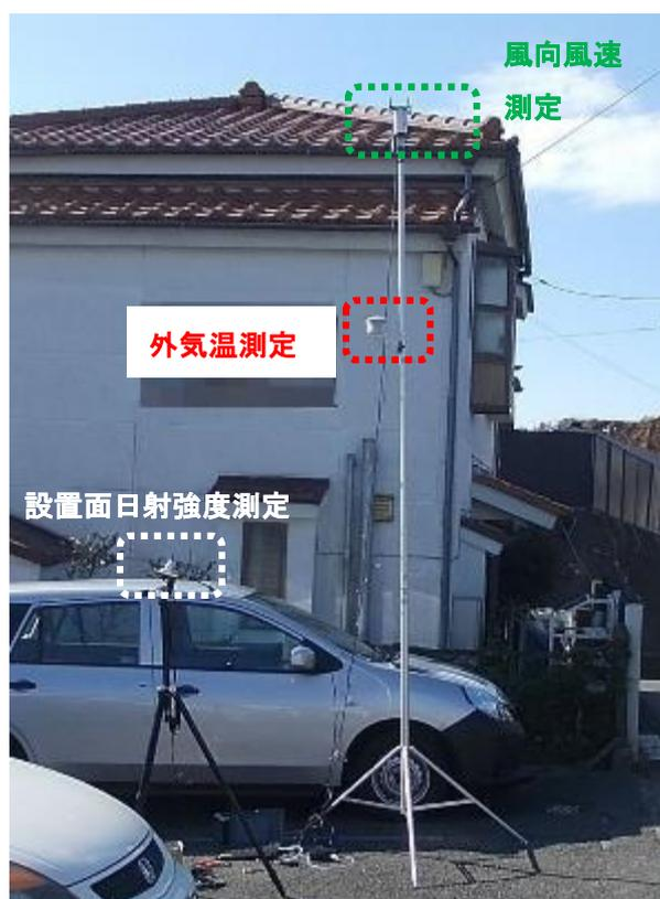
図 5.31. 横浜市 K 様邸 駐車場における測定器設置
