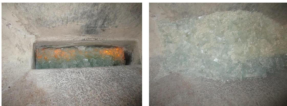
図 5.235. カバーガラス 50%-板ガラス 50%試料の熔融炉への投入外観
