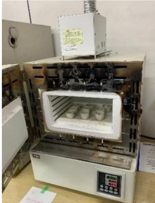
図 5.206. イグロス測定における電気炉へのるつぼのセット
