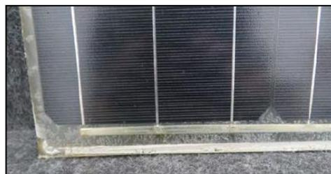
図 5.84. W2 の気泡発生状況（1000h 後）
