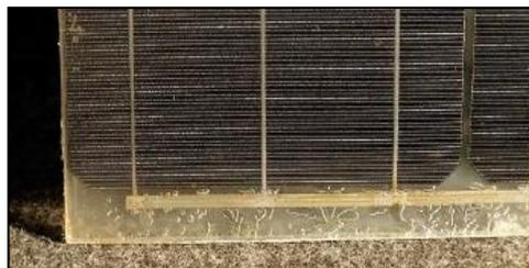
図 5.82. W1 の気泡発生状況（2000h 後）
