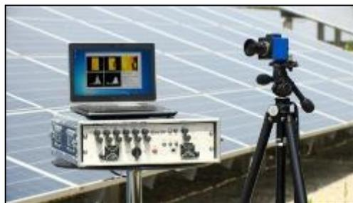
図 5.77. EL 検査装置
