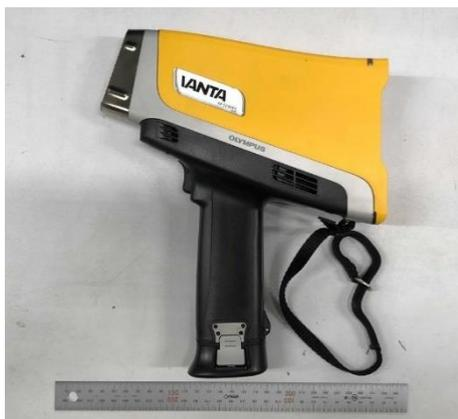
図 5.174. ハンドヘルド XRF 装置 (VANTA Geochem)
