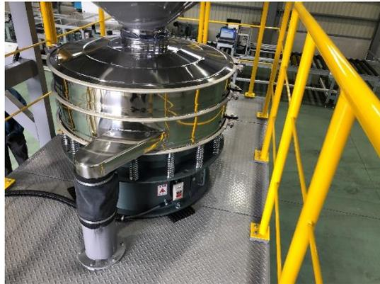
図 5.142. 実プロセスでの使用機器：粒度選別機
