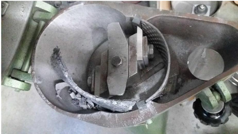
図 5.98. オリентミル（刃付けなし）のチャンバー内の様子
