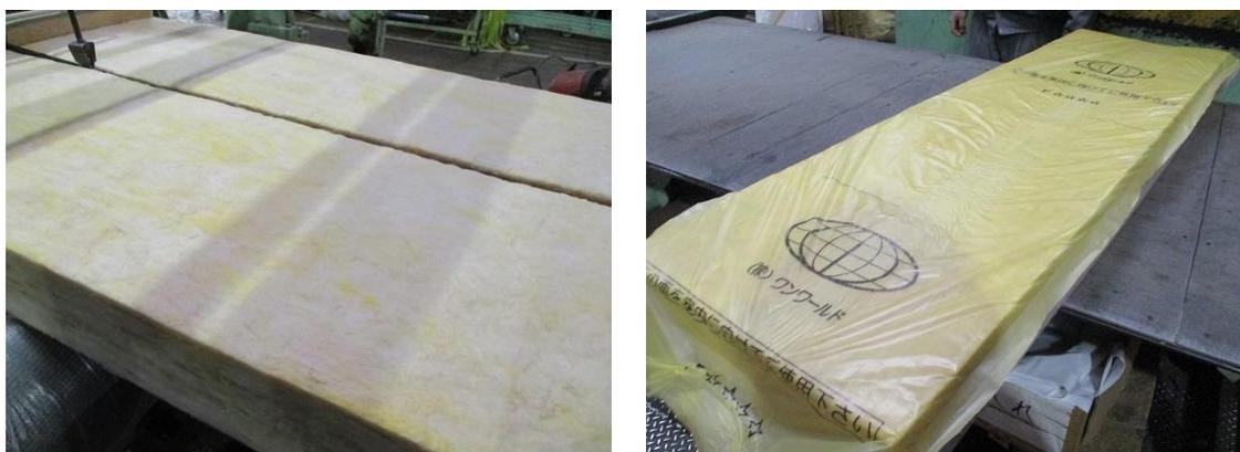
図 5.246（左）寸法裁断後写真、（右）被服完了製品写真
