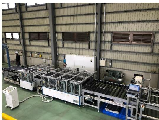
図 5.140. 実プロセスでの使用機器：ホットナイフ分離法®
