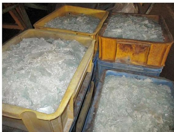
図 5.234. カバーガラス 50%-板ガラス 50%試料の熔融試験出発材料
