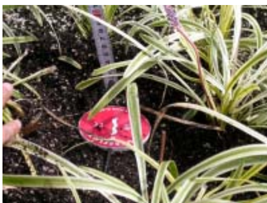
熱流計・熱電対設置状況（土壌中）
