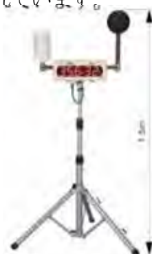
図 2-5 WBGT 測定装置の例 5 WBGTを自動的に計算する測定機器も市販されています。
