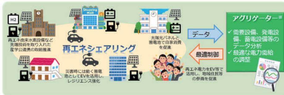
VPP：Virtual Power Plant(仮想発電所)。IoTやクラウドを活用し、あたかも1つの発電所のように、需要、発電、蓄電をまとめてコントロールする仕組み
