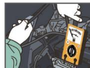
漏えい検知器による漏れ確認（定期点検）
