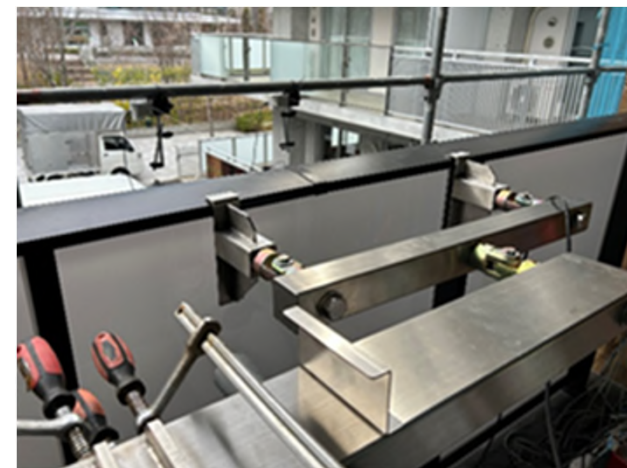
金属手摺強度試験
