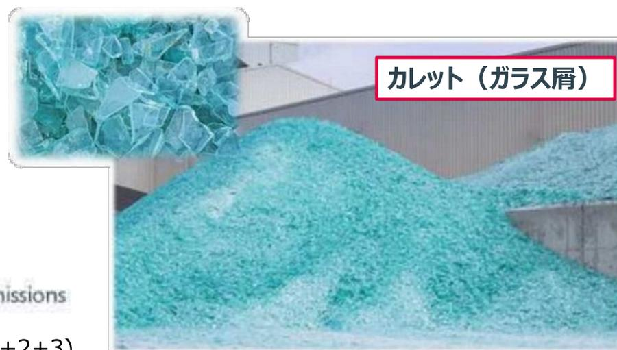
**GHG削減効果：**カレット（ガラス屑）はバージン原料よりも融けやすいことから、燃料の削減に繋がる。また、バージン原料に炭酸塩を使用しており、溶解時にCO<sub>2</sub>が発生するが、カレットを増やすと、炭酸塩の使用量が減少するため、CO<sub>2</sub>の発生を抑えることができる。
