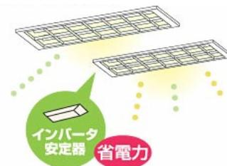
銅鉄型をインバータ型に更新し、蛍光管をFLR40形からFLR32形に更新した場合、照明電力消費量の**約24%省エネ**となります。
