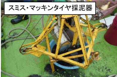
水深が浅く、海底の表面が固いため、重量のある採泥器を使用。それでも、1回に採取できる底土は、軟泥の地点に比べて少ない。
