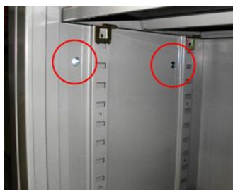
隣接した側面での連結 隣り合った棚の側面をボルトで連結している。
