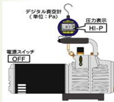
真空ポンプの大気圧表示
