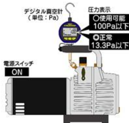
真空ポンプの到達真空度
