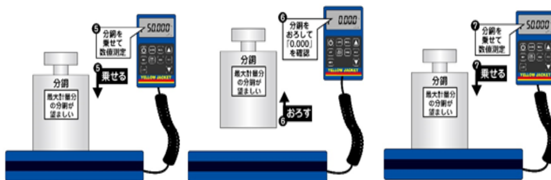
秤量付近再現性点検
