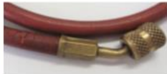
チャージングホースの劣化点 (Oリング、ひび割れ)
