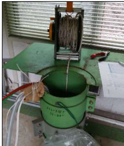
採水前後での井戸水位確認状況
