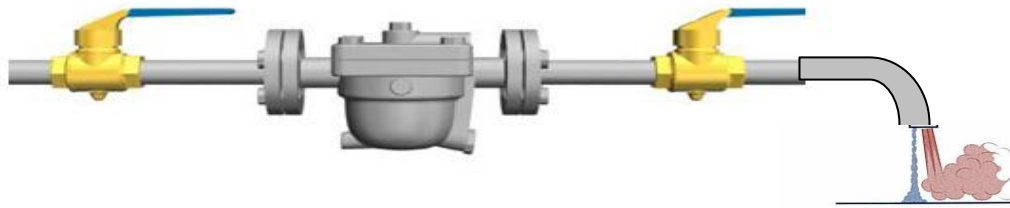
オリフィスからの蒸気噴出し量(kg/h)
