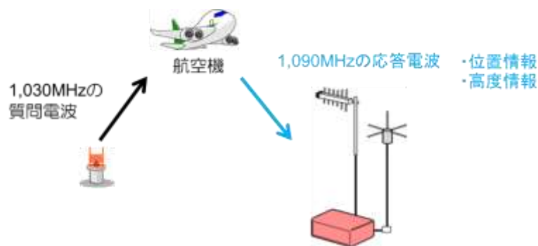
図 1-1-1. ADS-B 受信の仕組み
