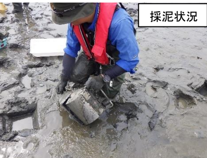
干潟に降り、小型の採泥器を用いて底泥を採取する。
