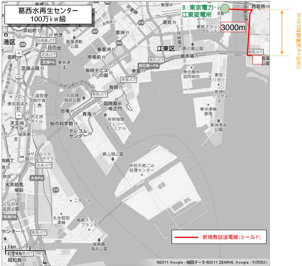
図 5 - 2 5 送電線敷設ルート (葛西水再生センター)
