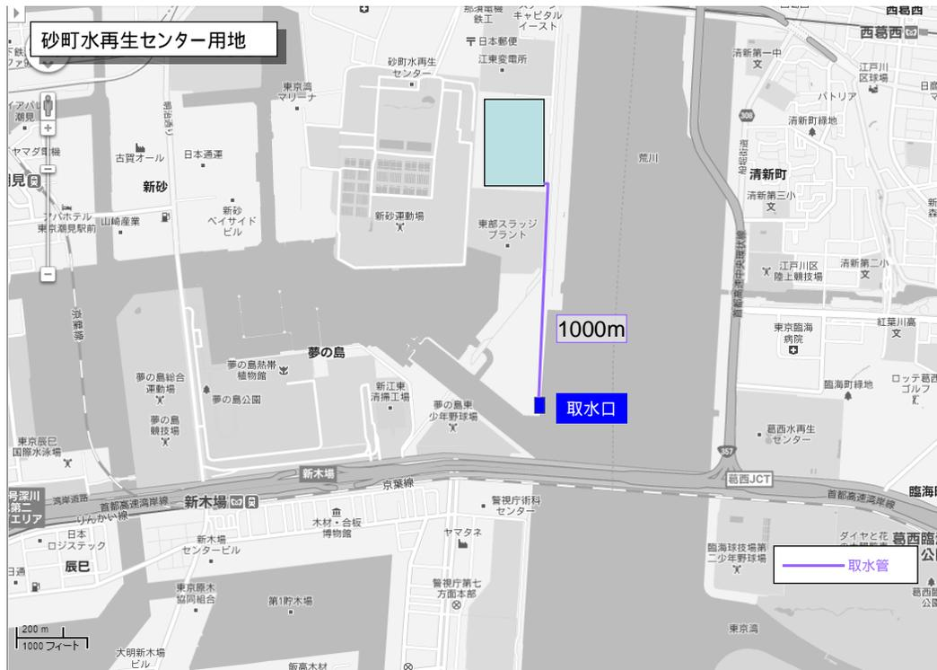
図 5 - 3 4 冷却水導管接続経路 (砂町水再生センター)
