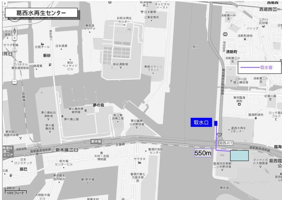
図 5 - 3 5 冷却用水道管接続経路 (葛西水再生センター用地)
