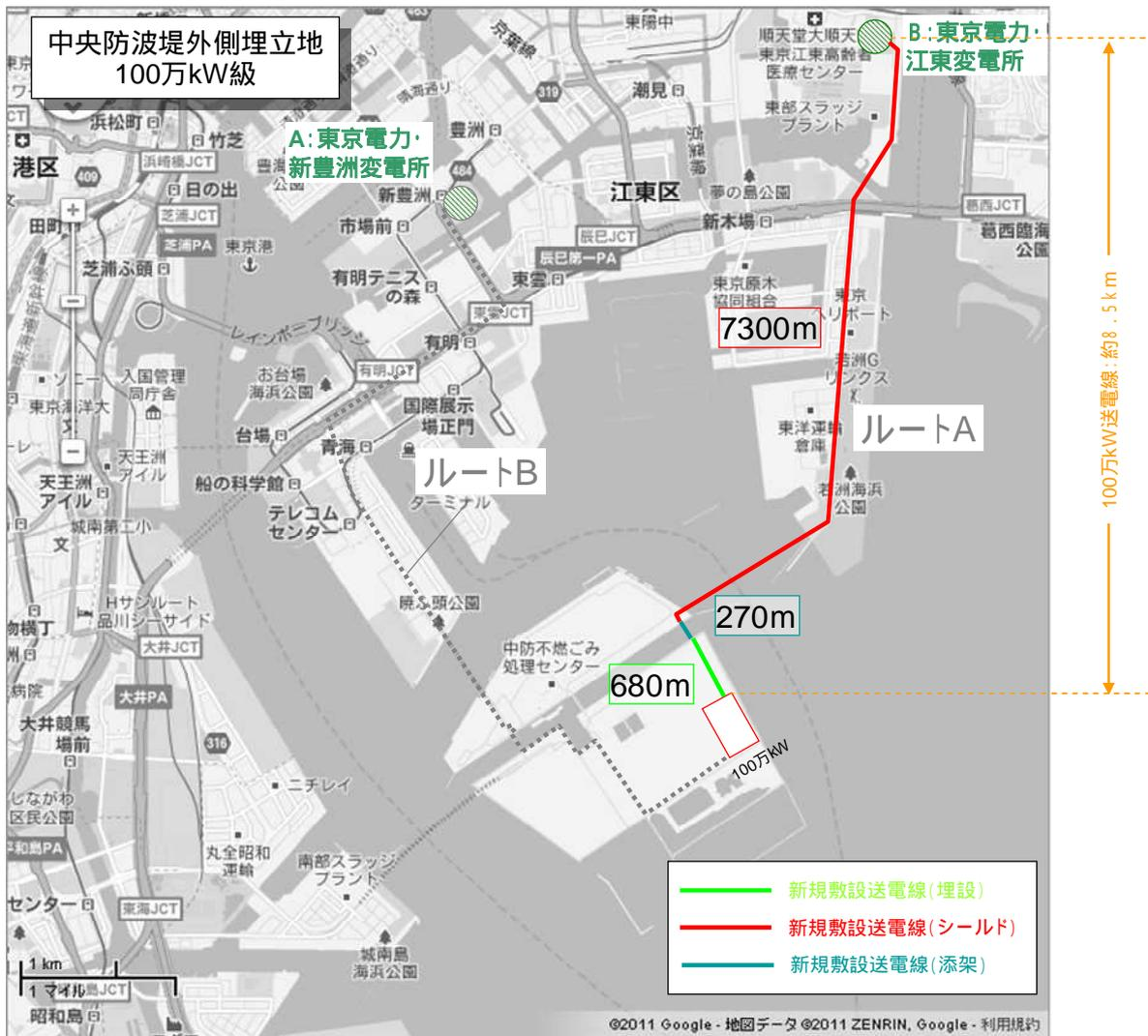
図 5 - 1 9 送電線敷設ルート (中央防波堤外側埋立地)
