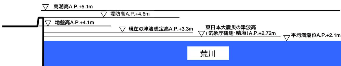
図 2 - 2 3 現状地盤高及び堤防高と高潮・津波時の水位の関係図（イメージ図）<sup>30</sup>
