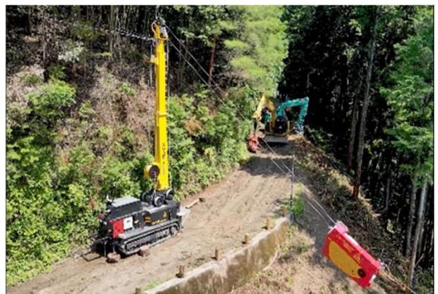
遠隔操作機能を搭載した先進林業機械
