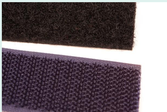
生物模倣の一例：ひっつき虫（オナモミ）を応用したマジックテープ
