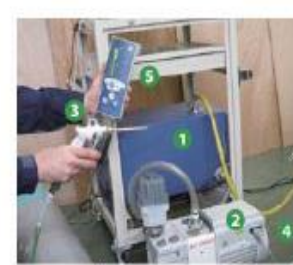
トレースガス法（水素、ヘリウム等による漏えい検知方式）
