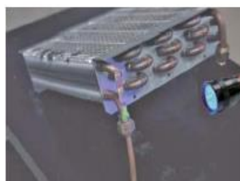
蛍光剤法（潤滑油中に蛍光剤を注入して蛍光ランプで検知）
