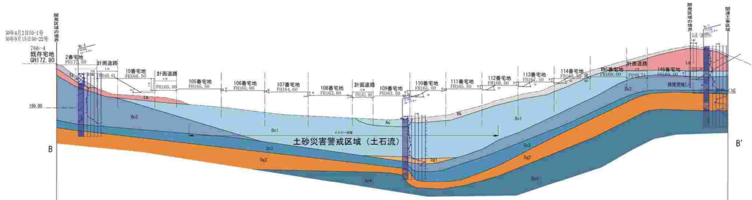
図 2-3 推定地層断面図 (B-B') S=1:600
