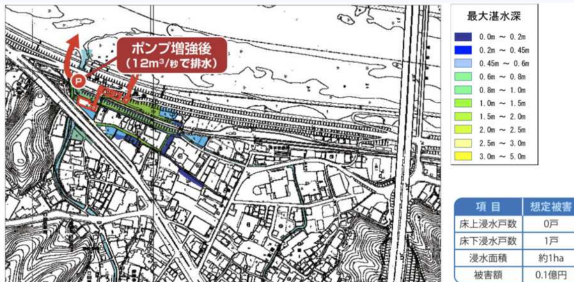
※概ね10年に1度の確率で発生する降雨に対する浸水状況(ポンプ増強後)
